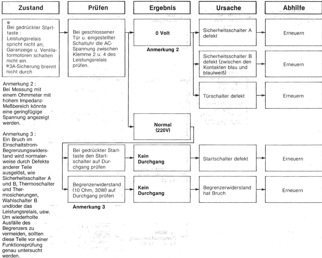
**[FEHLER 3]** Bei Einstellung auf 1600W
