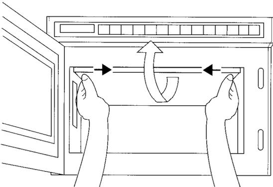
2. Reinigen Sie die Kunststoffabdeckung außerhalb des Gerätes.
