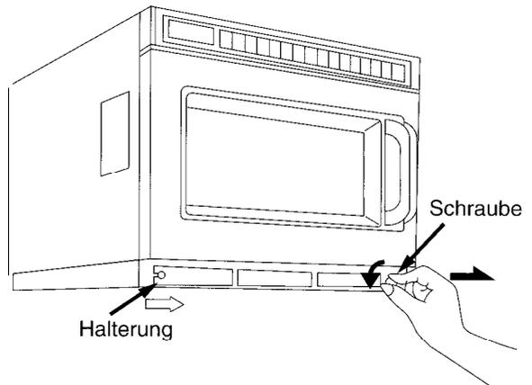
2. Reinigen Sie den Filter mit einem milden Reinigungsmittel.
